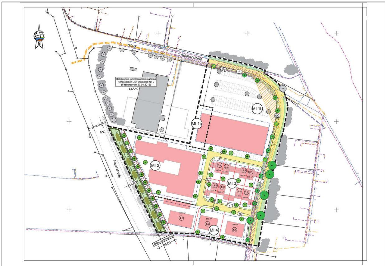
Das für die Verkehrslärberechnungen erforderliche 3-D-Geländemodell wurde aus den digitalen Daten /13/ entwickelt. Das Baugebungsplangebiet liegt bei 345 m im Nordosten und 351 m im Südwesten. Das digitale Geländemodell mit Plangebäuden (Annahme: Bauweise III), aktivem Schallschutz nach Anlage 1.3 und grafisch hinterlegtem Entwurf zum Baugebungs- und Grünordnungsplan Straßäcker-Ost-II ist nebenstehend dargestellt.
